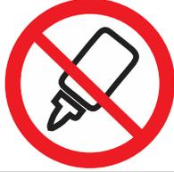
**Não colar:** Peças ou eixos móveis são somente encaixados ou posicionados. Caso haja colagem, poderá comprometer o funcionamento do mecanismo.
